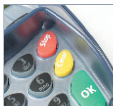
Tastatur mit ergonomischem Sichtschutz und taktilen Symbolen
